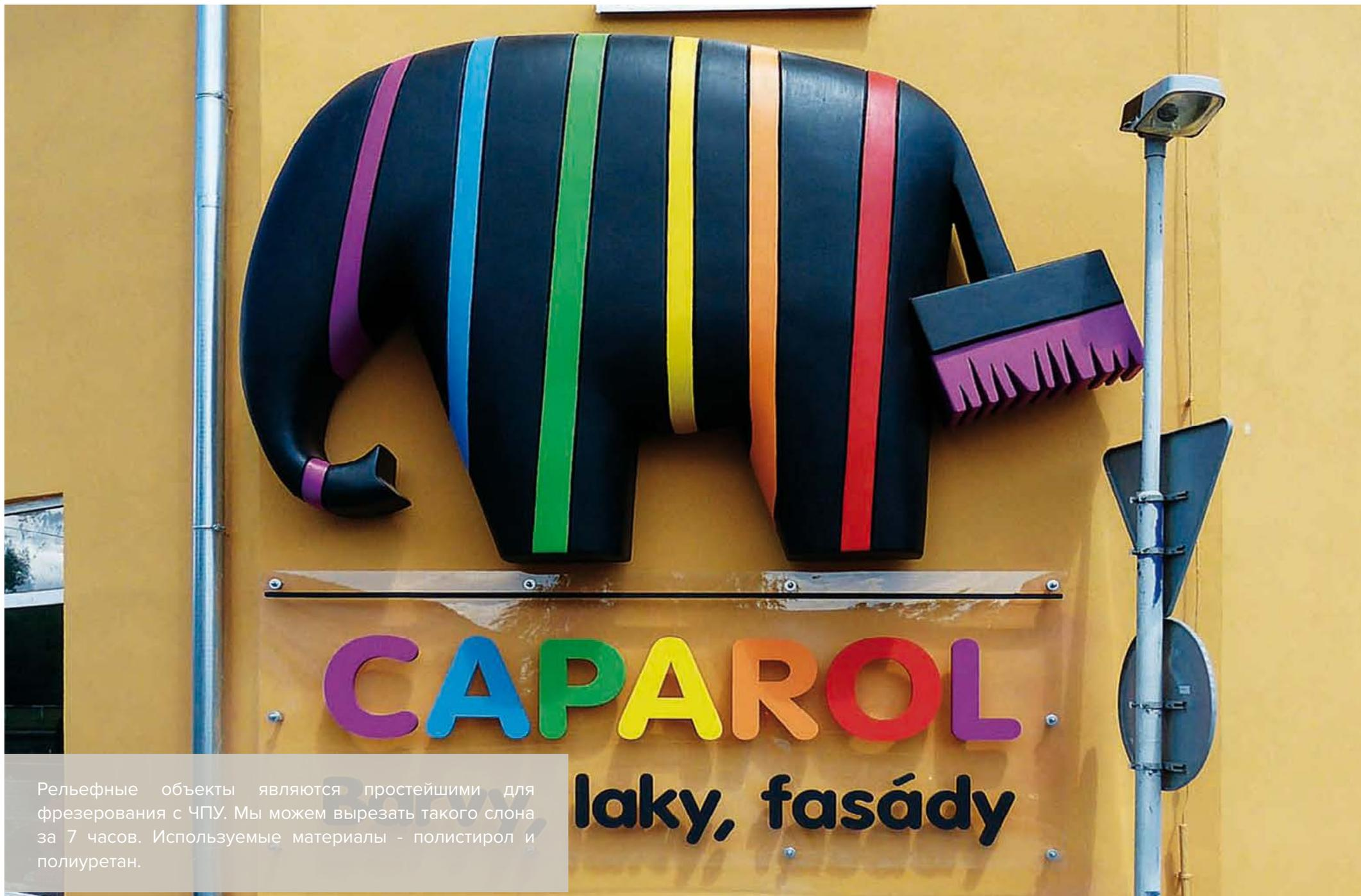
Рельефные объекты являются простейшими для фрезерования с ЧПУ. Мы можем вырезать такого слона за 7 часов. Используемые материалы - полистирол и полиуретан.
